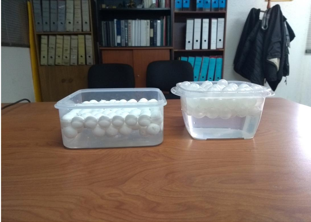
El deposito del lado izquierdo es con esferas macizas y las del lado derecho con esferas huecas
